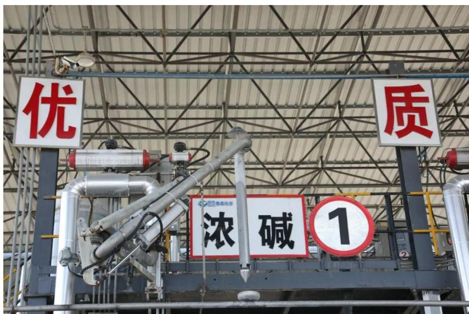
智能无人化充装。系统采用三维图像智能分析的方法对罐口进行识别和定位，根据定位软件计算得到的罐口坐标信息，引导对位系统进行自动精确对位，再加入算法计算灌口坐标，传给鹤管控制器，实
